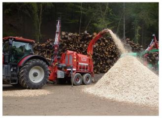
【チップ化のイメージ】 ※実際はコンテナに直接投入します
